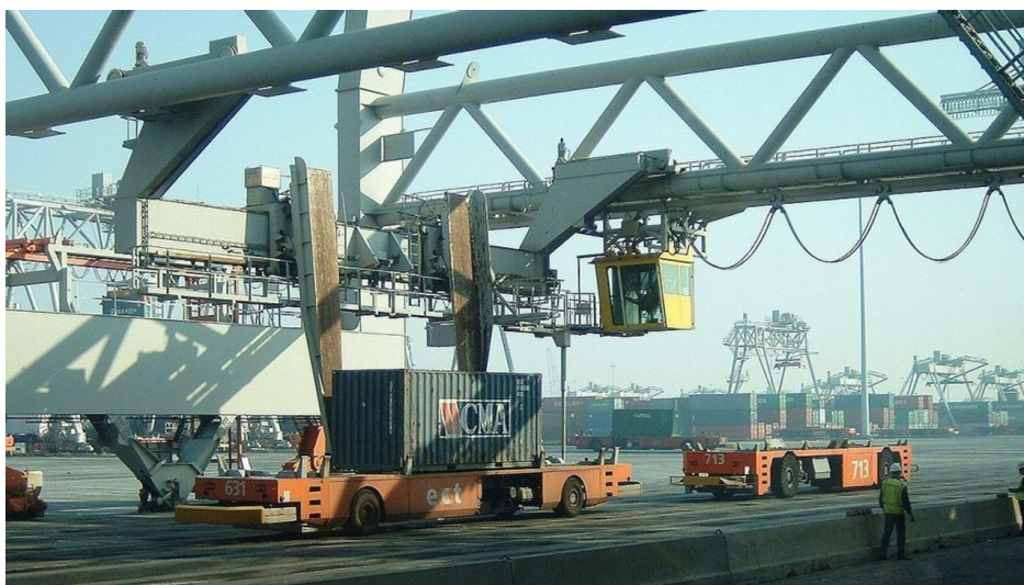
රොටර්ඩැම් නි කන්ටේනර් පර්යන්තයක මිනිසුන් රහිත ස්වයංක්‍රීය නියැලු (guided) වාහනයකට කන්ටේනරයක් පටවන ආකාරය [ඡායාරූපය: Quistnix / CC BY 1.0]
